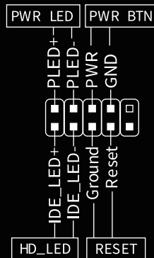
Conector Power/Reset/LED da Placa-Mãe
